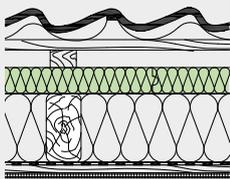
ISOLAIR kann gemäß ZVDH-Fachregelwerk als Unterdeckplatte der Klasse UDP-A eingesetzt werden.
