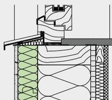
ISOLAIR als WDVS-Putzträgerplatte ist in der Zulassung PAVACASA verankert (Stärken 40 – 80mm). Die Holzfaser-Dämmplatte ist besonders für den Holzbau geeignet.
