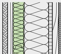
ISOLAIR ist ideal als diffusions-offene, wasserableitende Schicht bei Außenwänden in Holzbauweise mit Vorhangfassaden einsetzbar.
