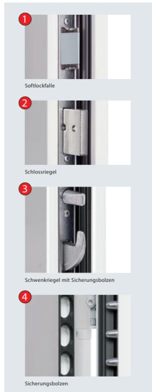
Einbruchschutz im Detail: Zwei konische Schwenkriegel rasten mit zwei zusätzlichen Sicherungsbolzen und einem Schlossriegel in die Schließbleche der Zarge ein und ziehen die Tür fest an. Auf der Bandseite machen drei weitere Sicherungsbolzen und die drei Rollenbänder ein Aushebeln der Tür praktisch unmöglich. Mit Softlockfalle für leises Schließen der Tür.
