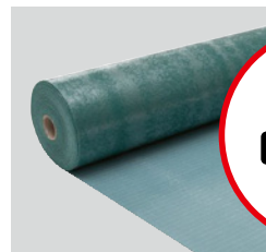
soundSTOP Unterlagsmatte aus Bio-Polyurethan, be- sonders leise, selbstklebend oben, haftend unten, für die stabile Klickverbindung Maße: 8.000×1.000×2 mm
