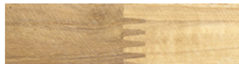
Plattenaufbau mit keilgezinkten Lamellen
