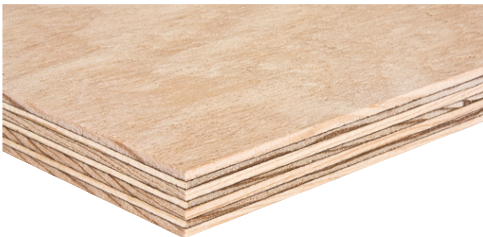
Sperrholz: Reduzierte Quell- und Schwindneigung durch kreuzweises Anordnen der Faserebenen.
