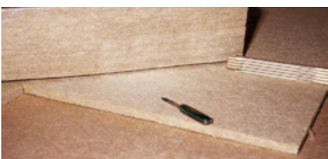
▷ Holzfaserdämmstoffe, Platten- oder Rollenware, z. B. als Naturprodukt aus Lignocellulosefasern, hergestellt im Nassverfahren oder im Trockenverfahren
