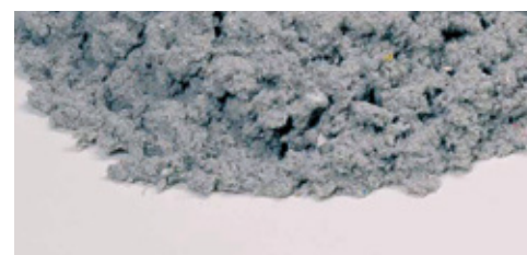
▷ Zellulosedämmstoff, Sackware. Verarbeitung („Einblasen in Hohlräume“) nur durch geschulte Fachbetriebe
