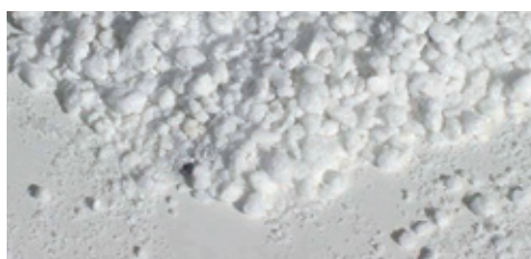
▷ Mineralischer Schüttdämmstoff aus thermisch expandiertem Mineral (Perlite, Bims, Glas, Ton)
