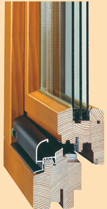
Abb. 49: Verantwortungsbewusste Energieeffizienz, Holzfenster mit 3-fach Verglasung: Ug-Nennwert: 0,7 W/m 2 K
