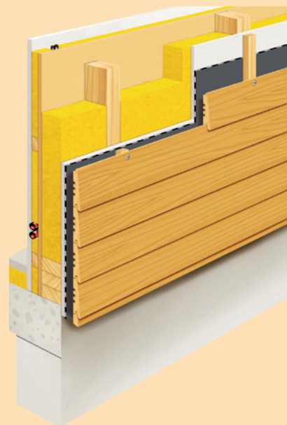
Abb. 38: Unterkonstruktion aus Holz auf Holzrahmenbau
