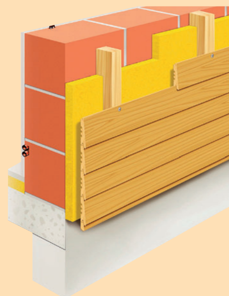
Abb. 39: Unterkonstruktion aus Holz auf Mauerwerk
