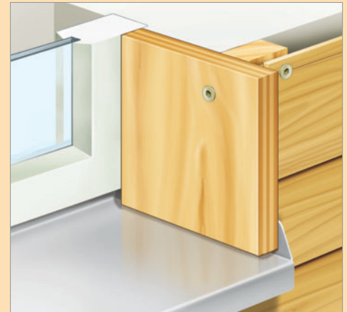
Abb. 90: Anschluss der Fensterbank. Leibungsbretter fassen darüber und sollen unten mindestens 10 mm Luft haben.
