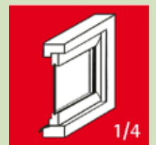
Ein altes, einfach verglastes Fenster dämmt nur ca. 20 db
