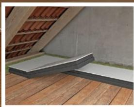
Ausbauplatten sind die klassischen Gipskartonplatten mit abgerundeter Kante ohne Fasern. Ihre Stabilität erhalten die Platten durch die beidseitige Kartontage. Wird die Kartonschicht mit einem Cuttermesser durchtrennt, kann die Platte leicht über einer Auflage nach hinten gebrochen werden.
