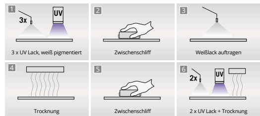
Lackaufbau einer HGM Tür mit Echtlack-Oberfläche
