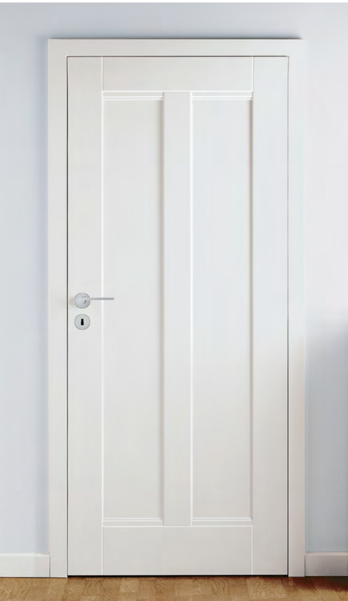
Tür S.4 mit Friesfuge, stumpf, Bänder verdeckt, Zarge S 70, Drücker BK.2
