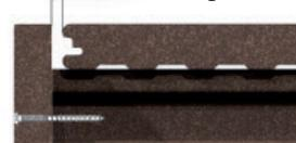
Zum Verdecken der Unterkonstruktion in Querrichtung (Dielen in Längsrichtung) befestigen Sie das Abschlussprofil mittels der Schraube an der Unterkonstruktion. Dabei ist das Vorbohren des Abschlussprofils mit einem 3,5-mm-Bohrer erforderlich.
