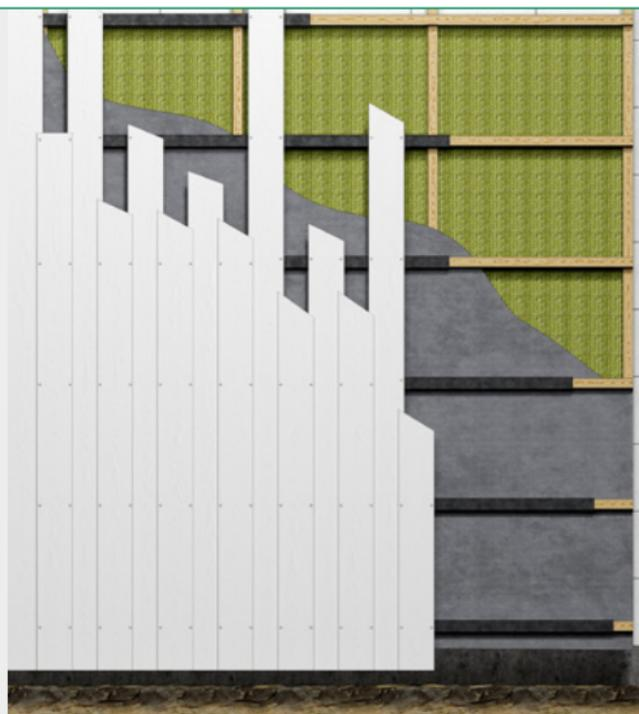
Anordnung der Boden-Deckel-Schalung.
