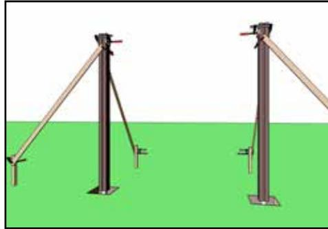
3) Die Pfosten mit Holzleisten und Schraubzwingen zum nachfolgenden Einbetonieren abstützen. Zwischen Schraubzwinde und Pfostenoberfläche kleine Hölzer legen, um Kratzer zu vermeiden! Nochmalige Kontrolle des korrekten Pfostenabstands und der senkrechten Ausrichtung!
