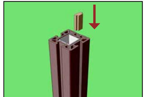
7) Obwohl die Profile direkt auf dem Untergrund verlegt werden können, empfehlen wir, ein jeweils ca. 3 cm langes Stück Nutleiste von oben in die Aufnahmenuten einzuschieben. Diese dienen als Distanzstücke unter dem unteren Füllprofil. In diesem Fall ist das untere Profilbrett mittig zu unterfüttern, so dass dieses nicht durchbiegt.
