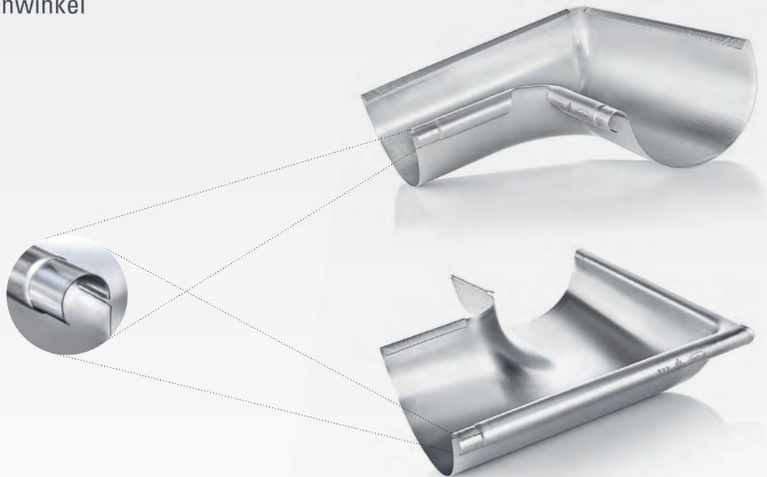
Der GRÖMO Rinnenwinkel ist ein funktionales Meisterwerk. Er erleichtert die Arbeit des Handwerkers enorm und macht umständliches Eindrehen überflüssig. Denn dank der eingezogenen Wulst mit Montagehilfe lässt sich der Rinnenwinkel einfach aufstecken.
