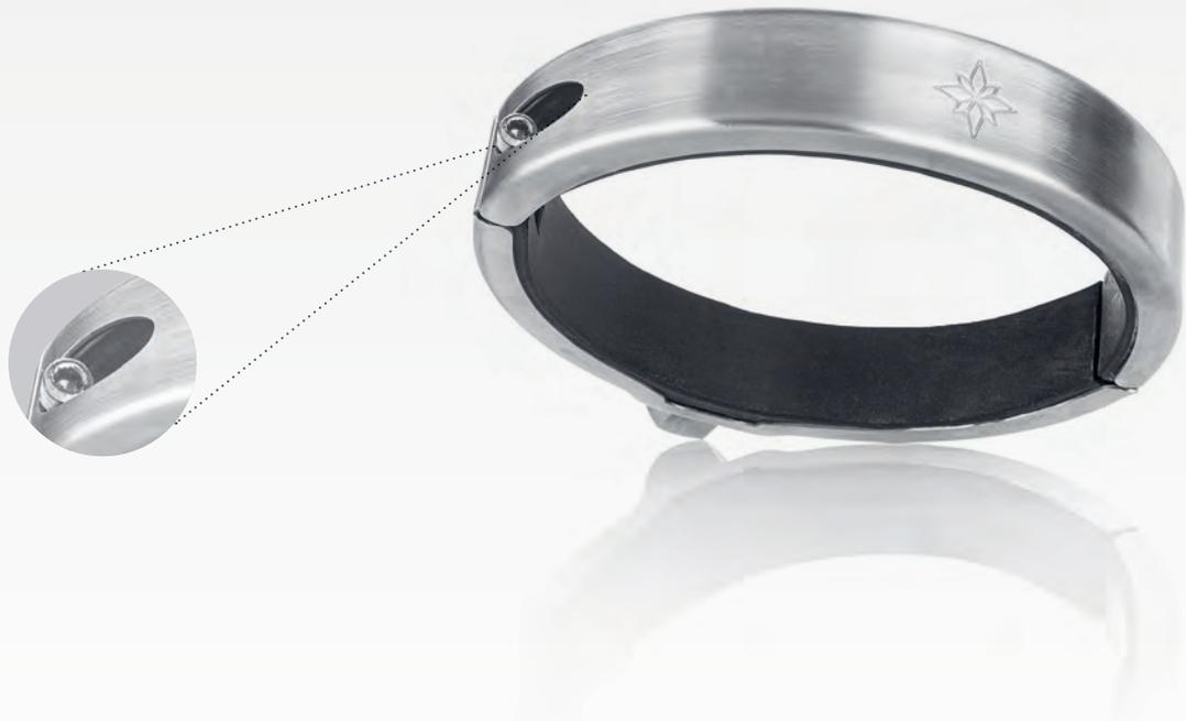
Durch ihre ansprechende Optik hebt sich die aus gebürstetem Edelstahl gefertigte Design-Fallrohrschelle von üblichen Rohrschellen ab. Eine in der Schelle verdeckt integrierte Schraube ermöglicht eine schnelle und zuverlässige Fixierung des Fallrohrs. Das eingepasste Gummiprofil gleicht Toleranzen beim Fallrohr aus, verhindert Kratzer und dient gleichzeitig als Schallschutz gegen Tropf- und Fließgeräusche. Durch die U-förmige Geometrie verfügt die Schelle über eine hohe Stabilität.
