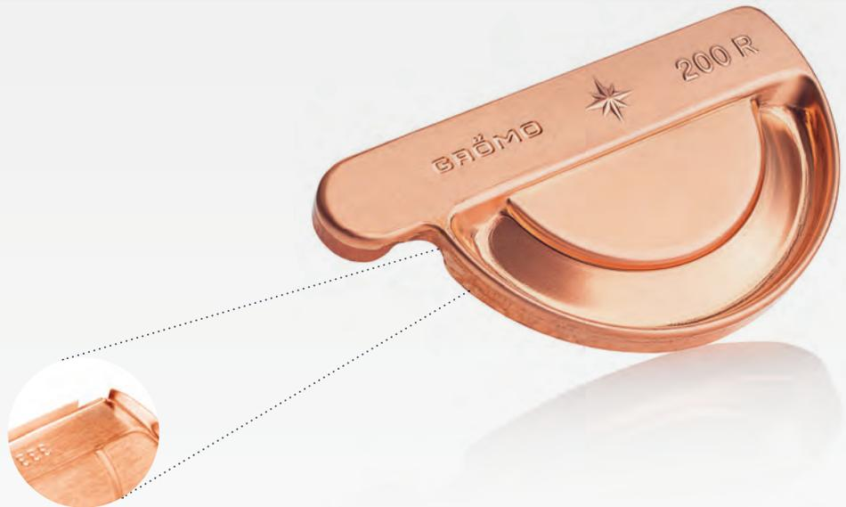
Mit dem GRÖMO Stechrinnenboden geht es schneller, sauberer und einfacher. Dank Einstecknut lässt er sich einfach an die Dachrinne stecken und hält von selbst. Sie haben freie Hand zum Löt- oder Kleben. Ein Wegspringen – wie es bei anderen Löt- oder Klebrinnenböden möglich ist – wird durch die Einstecknut verhindert.
