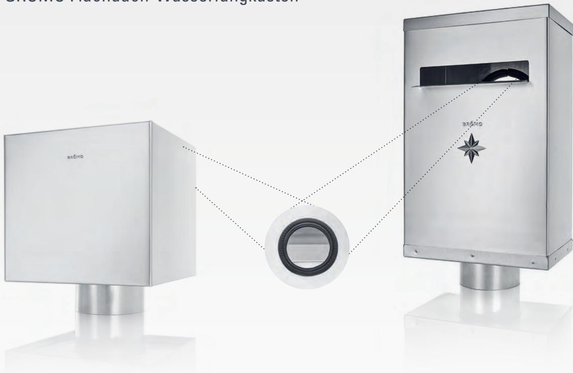
Für einfache Montage sorgen die vorgestanzte Zulauföffnung (NG 75/NG 100/NG 110) und die vormontierte Dichtung. Wo bisher langwierig ausgeschnitten und angepasst werden musste, können die Kästen jetzt spielend leicht durch die vorbereitete Zulauföffnung auf das Rohr gesteckt und direkt an der Wand montiert werden. Zudem überzeugen die Flachdach-Wasserfangkästen durch ihre ästhetischen Formen, geschaffen für die moderne Architektur von heute.
